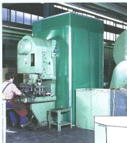
Maschinenkapselung mit Optiduuu Lärmschutzfolie
